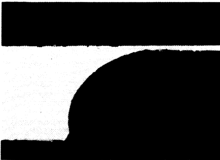
Bild 9: Querschliff einer isotrop geätzten Membrane
